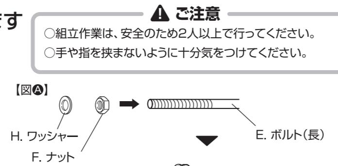
②E.ボルト(長)を重ね合わせたA.サポートに差し込み、F.ナットを取り付けます。【図B】
